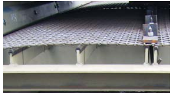
Aplicación de los burletes en zaranda.
